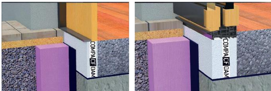
Uložení dveří na pevnou tepelnou izolaci Compacfoam
